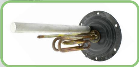
Les résistances blindées répondent aux besoins pour des eaux douces peu entartrantes ou agressives. La résistance blindée est en contact direct avec l'eau avec une anode en magnésium pour la protection anti-corrosion. Le fonctionnement est en 240 V monophasé uniquement.
