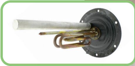
Les résistances blindées répondent aux besoins pour des eaux douces peu entartrantes ou agressives. La résistance blindée est en contact direct avec l'eau avec une anode en magnésium pour la protection anti-corrosion. Le fonctionnement est en 240 V monophasé uniquement.
