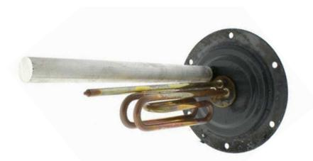
Les résistances blindée répondent aux besoins d'entrée de gamme pour des eaux douces peu entartrantes ou agressives. La résistance blindé est en contact direct avec l'eau avec une anode en magnésium pour la protection anti-corrosion. Le fonctionnement est en 240 V monophasé uniquement.
